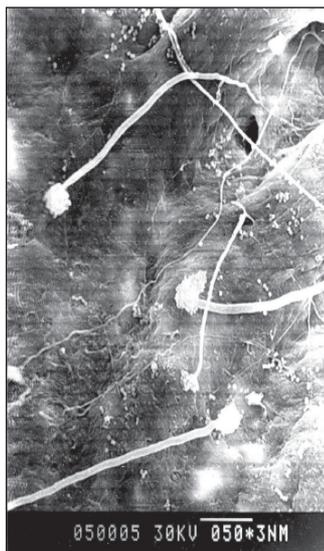
Рис. 3. Контрольный образец хромированного кожевенного п/ф на 30 сутки термостатирования. ЭСМ – 340.
