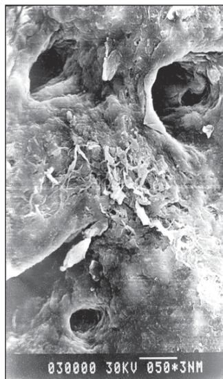
Рис. 4. Образец хромированного кожевенного п/ф, обработанный препаратом «Экоантисепт». (30 суток термостатирования). ЭСМ – 340.
