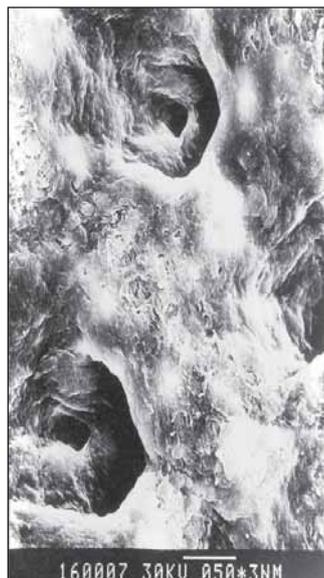
Рис. 2. Образец хромированного кожевенного п/ф, обработанный препаратом «Экоантисепт» (14 суток термостатирования). ЭСМ – 340.
